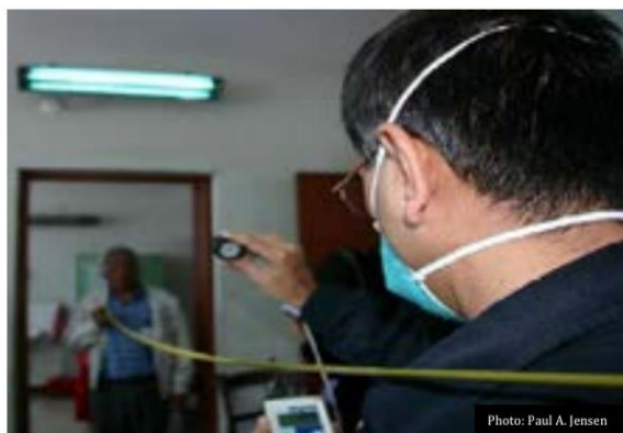
Hình 14. Đo hiệu suất của các GUV254 và Người thực hiện đo phải đeo kính bảo vệ mắt trong quá trình đo
