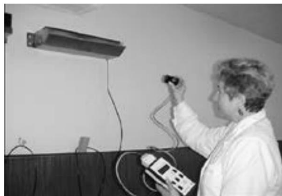
Hình 14. Đo hiệu suất của các GUV254 và Người thực hiện đo phải đeo kính bảo vệ mắt trong quá trình đo
