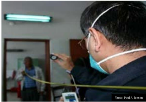
Hình 9. Đo hiệu suất của các GUV 254 và Người thực hiện đo phải đeo kính bảo vệ mắt trong quá trình đo
